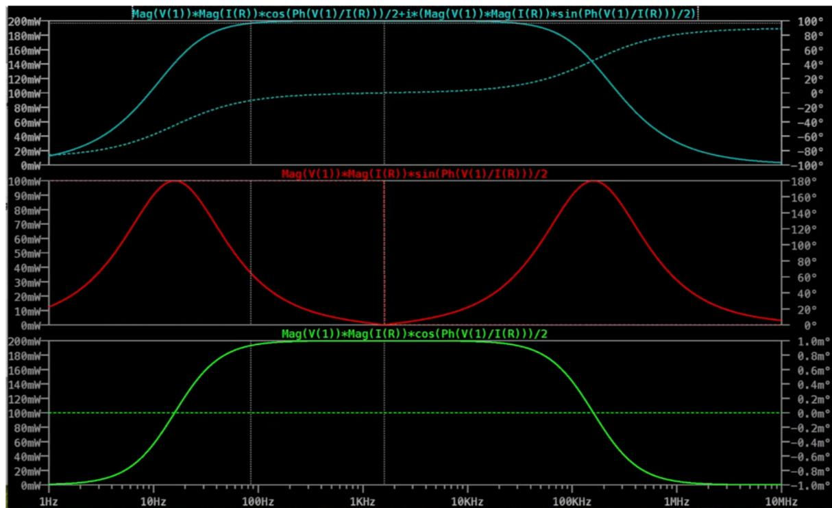
Mais nous pouvons afficher la puissance apparente en watts en additionnant simplement la puissance active et  $i$  multiplié par la puissance réactive.
