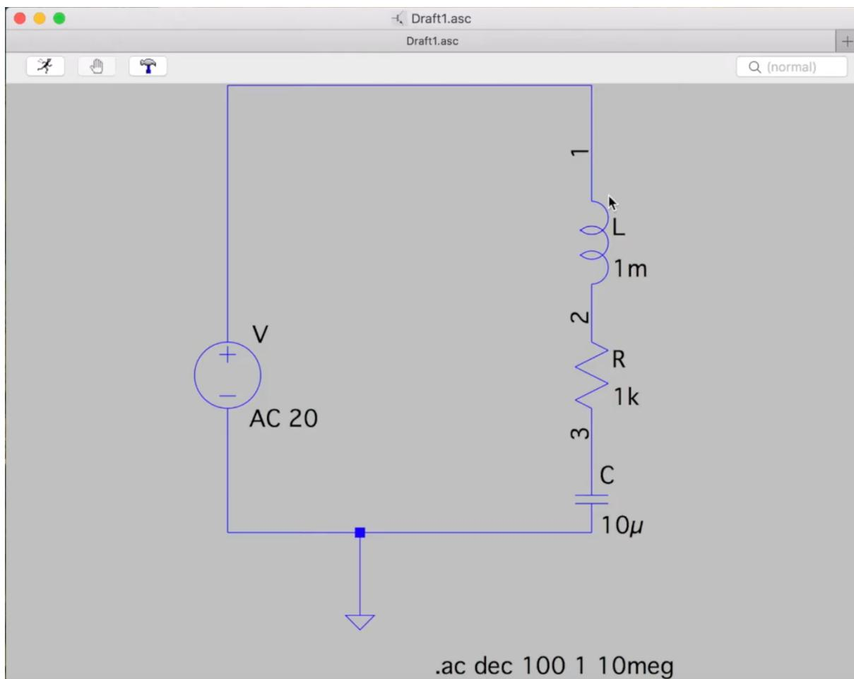
À partir du circuit RLC créé dans la vidéo 2, nous réalisons une analyse fréquentielle avec 100 points de mesure par décade et sur une bande passante assez large (de 1Hz à 1MHz) avec la commande « `.ac dec 100 1 10meg` ».
