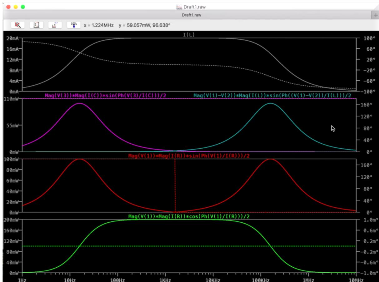
Nous pouvons, au moyen du courant qui les traverse multiplié par la tension, multiplié par le déphasage (cf. cours) calculé la puissance consommée par l'inductance et la capacité. L'addition de ces deux valeurs nous donne logiquement la puissance réactive. En observant le courant dans le circuit ainsi que les puissances respectives nous pouvons constater les propriétés suivantes :
