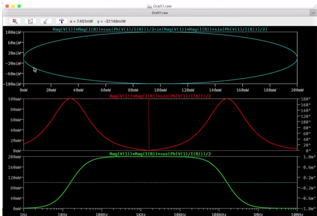
Grâce à un diagramme de Nyquist, nous pouvons afficher la puissance active en fonction de la puissance réactive. (la partie imaginaire en fonction de la partie réelle)
